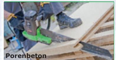
**Robuste Bauweise mit langlebigem, leistungsstarkem 1.800 W Motor**
